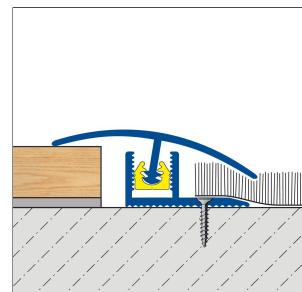
Taco laminado LS 42 de PVC para fijar perfiles MULTIFLOOR en 270 cm de longitud, cantidad recomendada por metro: 5 unidades, para brocas de Ø 6,0 mm.
