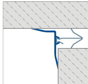
Clips de sujeción de inox (V4A/304) A o B (dependiendo del ancho de la junta)
